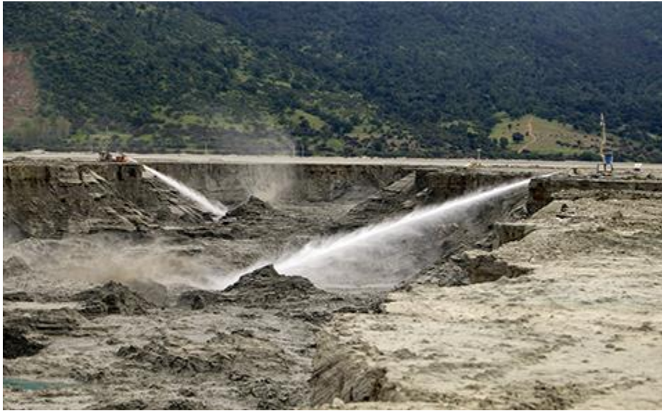
Ilustración 3: Monitoreo Hidráulico Operando. Fuente: MVC.
