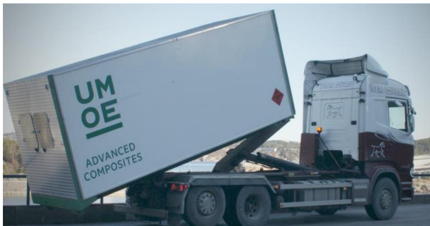
Figura 55: Modelo de almacenamiento de hidrógeno en container.
