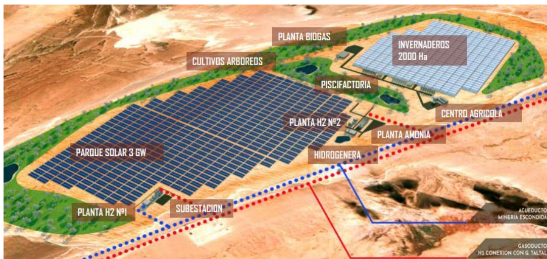
Figura 60: Esquema de instalación del proyecto Hoasis.
