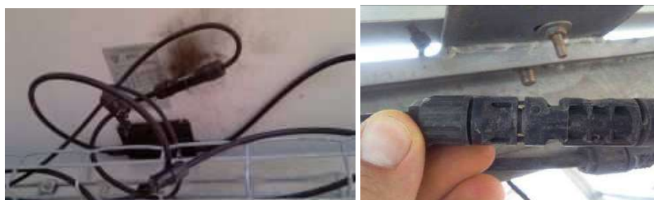
ILUSTRACIÓN 56 IZDA: CONECTORES QUEMADOS POR MALA CONEXIÓN (FUENTE: DGS BERLIN E. V.); DCHA: CONECTOR NO DEBIDAMENTE CERRADO (FUENTE: PI BERLIN AG)
