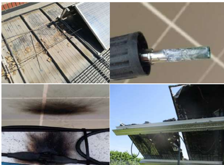
ILUSTRACIÓN 13 IZQ. ARRIBA: ACUMULACIÓN DE HOJAS SECAS EN LA PLANTA FOTOVOLTAICA. DER. ARRIBA: CONECTOR CORROÍDO. IZQ. ABAJO: EXPLOSIÓN EN CONECTOR POR ACUMULACIÓN DE POLVO; DER. ABAJO: PANEL FV INCENDIADO (FUENTE: PI BERLÍN AG)
