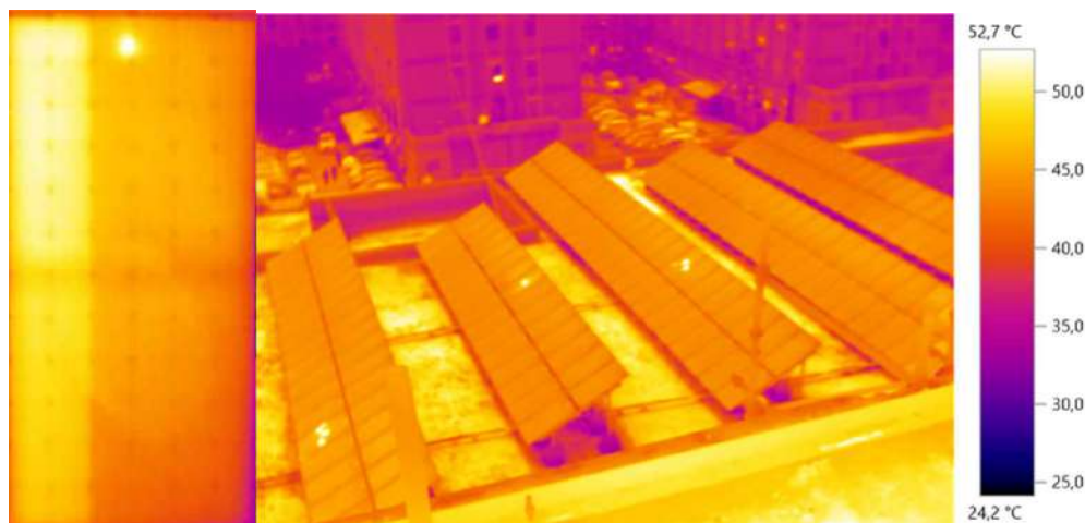
ILUSTRACIÓN 31 IZDA: STRING DE CELDAS INACTIVO; DRCHA: PRESENCIA DE HOT SPOTS (FUENTE: PI BERLÍN AG)
