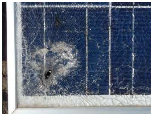
ILUSTRACIÓN 44 ROTURA DE MÓDULO POR IMPACTO MECÁNICO - REEMPLAZAR EL MÓDULO. (FUENTE: PI BERLIN AG)
