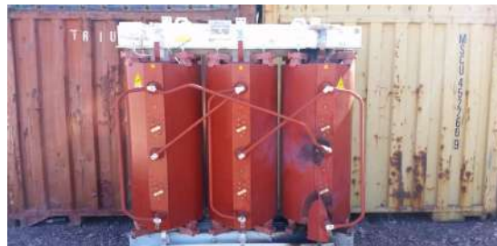
ILUSTRACIÓN 76 TRANSFORMADOR DE RESINA DAÑADO POR VENTILACIÓN INADECUADA Y ACUMULACIÓN DE POLVO (FUENTE: PI BERLIN AG)
