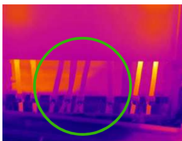
ILUSTRACIÓN 70 INTERRUPCIÓN DE LA CORRIENTE EN VARIOS STRINGS A LA ENTRADA DE LA CAJA DE COMBINACIÓN . FOTO REALIZADA CON UNA CÁMARA DE INFRARROJOS (FUENTE: PI BERLIN AG)
