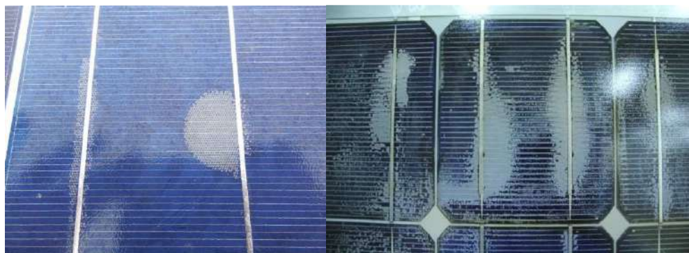
ILUSTRACIÓN 46 DELAMINACIÓN DEL MÓDULO (FUENTE: PI BERLÍN AG)
