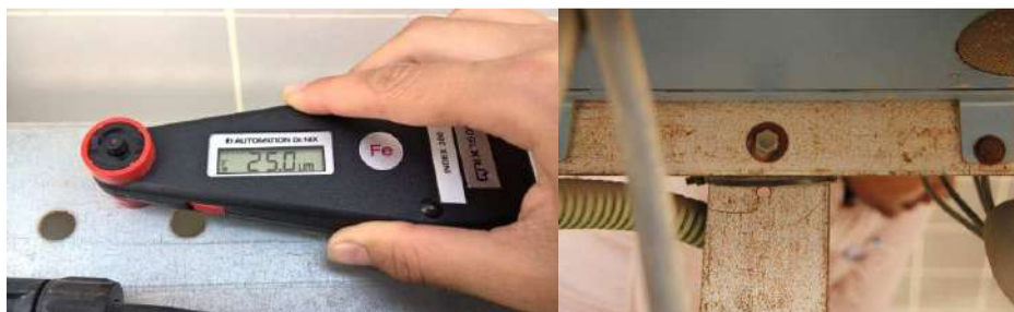
ILUSTRACIÓN 66 IZQ: MEDICIÓN DE LA CAPA DE GALVANIZADO DEL PERFIL TRANSVERSAL DE LA ESTRUCTURA DE SUJECCIÓN DE LOS PANELES (FUENTE: PI BERLÍN AG); DER: OXIDACIÓN DE LA SUPERFICIE DE LA ESTRUCTURA DE SUJECCIÓN DE LOS PANELES (FUENTE: PI BERLÍN AG)
